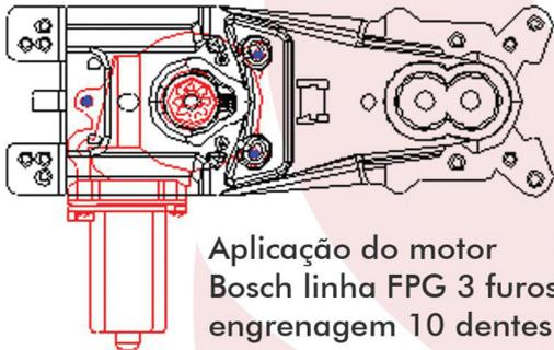
Aplicação do motor Bosch linha FPG 3 furos, engrenagem 10 dentes
