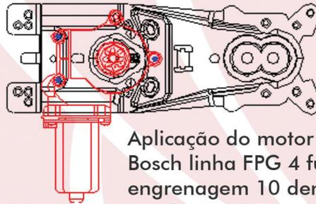
Aplicação do motor Bosch linha FPG 4 furos, engrenagem 10 dentes e 8 dentes INTELIGENTE
