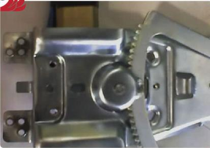
Localize os furos com rosca nos furos do chassi rotacionando o motor como apropriado
