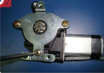
Parafuse o suporte de fixação do motor ao motor
