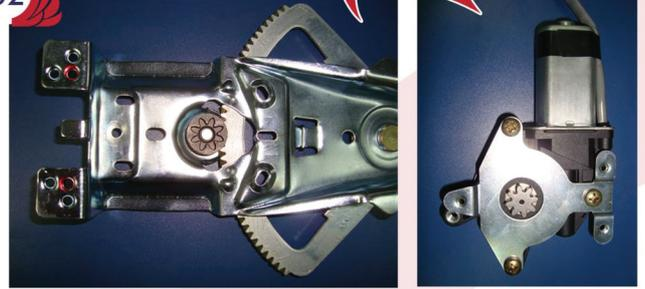
Encaixe o arrastador da engrenagem no pinhão do motor
