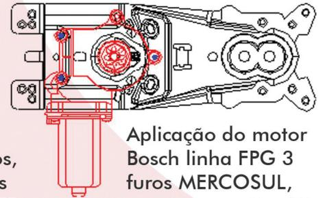
Aplicação do motor Bosch linha FPG 3 furos MERCOSUL, engrenagem 8 e 10 dentes
