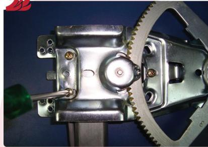
Parafuse o corpo da máquina ao suporte de fixação do motor
