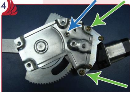
Parafuse o adaptador ao chassi utilizando parafusos m6 x 10mm nas posições identificadas pelas setas verdes e parafuso m6 x 20mm na posição indicada pela seta azul na figura.
