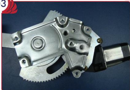
Encaixe a engrenagem do motor no alojamento da engrenagem fixada no chassi da peça, de forma a girá-la afim de posicionar a furação do adaptador com a furação do chassi.
